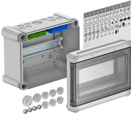
Kleinverteiler mit Klemmleiste zur Aufputz-Montage, für die Strom-Unterverteilung im Innen- und geschützten Außenbereich, gemäß IEC 439-3. Mit vormontierter 35-mm-Hutprofilschiene. Schutzart IP66 und Schutzgrad IK06. Transparenter Deckel zum Schrauben, mit Ausschnitt.
