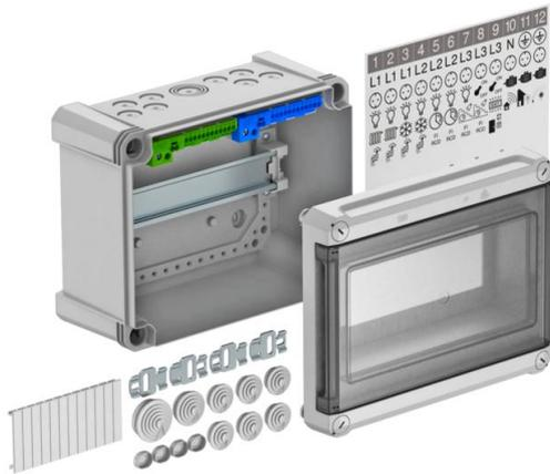
Kleinverteiler mit Klemmleiste zur Aufputz-Montage, für die Strom-Unterverteilung im Innen- und Außenbereich, gemäß IEC 439-3. Mit vormontierter 35-mm-Hutprofilschiene. Schutzart IP66 und Schutzgrad IK06. Transparenter Deckel zum Schrauben, mit Ausschnitt.
