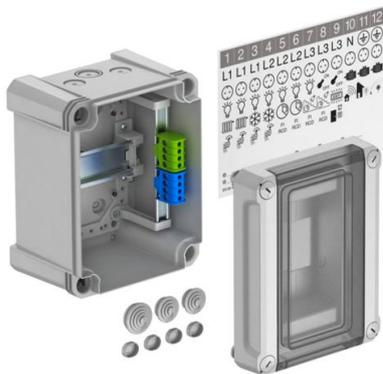
Kleinverteiler mit Klemmleiste zur Aufputz-Montage, für die Strom-Unterverteilung im Innen- und geschützten Außenbereich, gemäß IEC 439-3. Mit vormontierter 35-mm-Hutprofilschiene. Schutzart IP66 und Schutzgrad IK06. Transparenter Deckel zum Schrauben, mit Ausschnitt.
