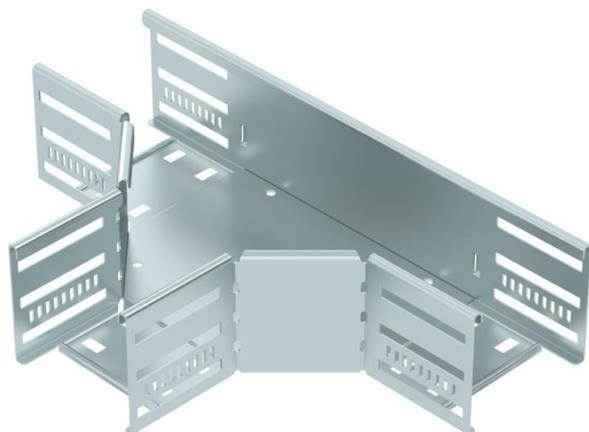
T-Stück zum Erstellen einer horizontalen Abzweigung, Formteil für rast- und schraubbare Kabelrinnen Seitenhöhe 85 mm. Schraubenlose Montage mit Doppelklemmen oder Schraubverbindung mit Flachrundschrauben FRS und Kombimuttern M6. Einsetzbar im Innenbereich. Befestigungsmaterial muss separat bestellt werden.
