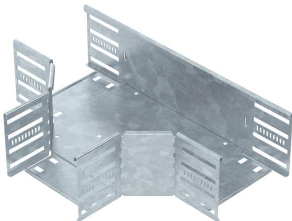
T-Stück zum Erstellen einer horizontalen Abzweigung, Formteil für rast- und schraubbare Kabelrinnen Seitenhöhe 110 mm. Schraubenlose Montage mit Doppelklemmen oder Schraubverbindung mit Flachrundschrauben FRS und Kombimuttern M6. Einsetzbar im Innen- und Außenbereich. Befestigungsmaterial muss separat bestellt werden.
