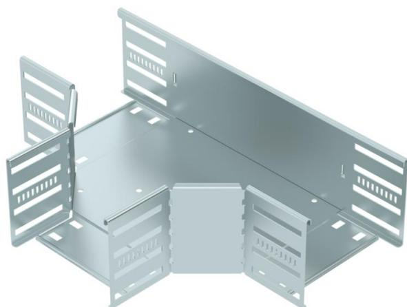
T-Stück zum Erstellen einer horizontalen Abzweigung, Formteil für rast- und schraubbare Kabelrinnen Seitenhöhe 110 mm. Schraubenlose Montage mit Doppelklemmen oder Schraubverbindung mit Flachrundschrauben FRS und Kombimuttern M6. Einsetzbar im Innenbereich. Befestigungsmaterial muss separat bestellt werden.
