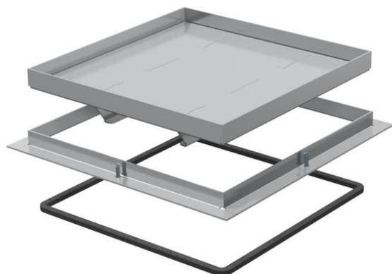
Rahmenkassette Schwerlast "blind" für die Herstellung einer Revisionsöffnung in der UZD350-3 in trocken oder nass gepflegten Fußböden. Belastungsklasse 2 bis 20 kN. Nur für glatte Bodenbeläge im Innenbereich geeignet.
