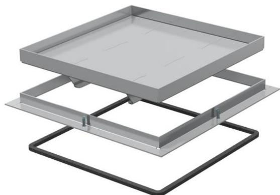
Rahmenkassette Schwerlast "blind" für die Herstellung einer Revisionsöffnung in der UZD350-3 in trocken oder nass gepflegten Fußböden. Belastungsklasse 1 bis 10 kN. Nur für glatte Bodenbeläge im Innenbereich geeignet.
