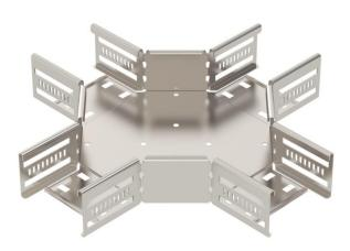
Kreuzung zum Erstellen einer horizontalen Abzweigung, Formteil für rast- und schraubbare Kabelrinnen Seitenhöhe 60 mm. Schraubenlose Montage mit Doppelklemmen oder Schraubverbindung mit Flachrundschrauben FRS und Kombimutter M6. Einsetzbar im Innen- und Außenbereich. Befestigungsmaterial muss separat bestellt werden.
