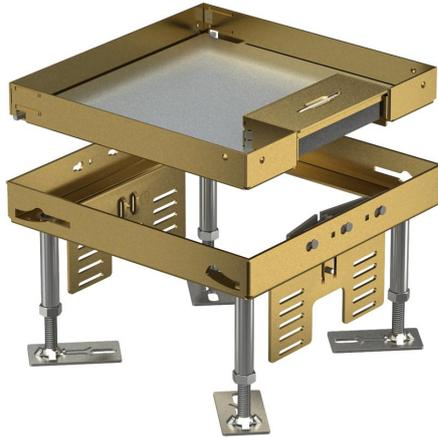
Nivellierbare Kassette der Nenngröße 4 mit SchnurAuslass für den Einbau von Installationsgeräten in trocken gepflegten Fußböden im Innenbereich. Nivellierbare Kassette mit SchnurAuslass, 2-zügig. Es können 2 Abdeckplatten APMT2 installiert werden. Für den Einbau von 2 Universalträgern UT3 für 4 Einzel-Installationsgeräte mit Tragering/Tragebügel oder 6 Modul 45-Geräte.
