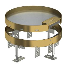
Nivellierbare Kassette der Nenngröße R7 mit Schnurauslass für den Einbau von Installationsgeräten in trocken gepflegten Fußböden im Innenbereich. Nivellierbare Kassette mit Schnurauslass, 3-zügig. Es können 2 Abdeckplatten APMT2 und eine APMT5 installiert werden. Für den Einbau von 2 Universalträgern UT3 und einem UT4 für 7 Einzel-Installationsgeräte mit Tragering/Tragebügel oder 10 Modul 45-Geräte.
