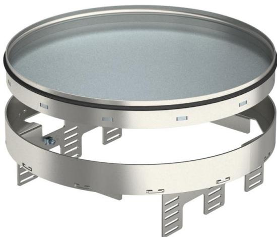
Nivellierbare und vom Fußboden entkoppelte Kassette "blind" für die Herstellung einer Revisionsöffnung der Nenngröße R9 in trocken oder nass gepflegten Fußböden im Innenbereich, zur Montage in Unterflurdosen UZD350-3 in Verbindung mit einem Montagedeckel DUG350-3R9 oder in UGD350-3R9. Die Montage erfolgt mittels Nivellierwinkel (separat bestellen) im Aluminium-Rahmenprofil der Unterflurdosen. Nur für glatte Bodenbeläge geeignet.
