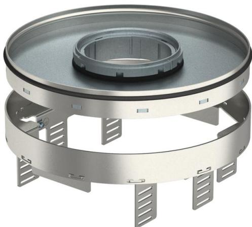
Nivellierbare und vom Fußboden entkoppelte Kassette der Nenngröße R7 für Tubus für den Einbau von Installationsgeräten in trocken oder nass gepflegten Fußböden im Innenbereich, zur Montage in Unterflurdosen UZD350-3 in Verbindung mit einem Montagedeckel DUG350-3R7 oder in UGD350-3R7. Die Montage erfolgt mittels Nivellierwinkeln (separat bestellen) im Aluminium-Rahmenprofil der Unterflurdosen.
