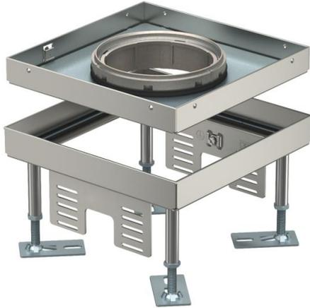
Nivellierbare quadratische Kassette für Tubus der Nenngröße 4 für den Einbau von Installationsgeräten in Kanalsystemen, Doppel- und Holzböden in trocken oder nass gepflegten Fußböden im Innenbereich. Schutzklasse: IP X5.
