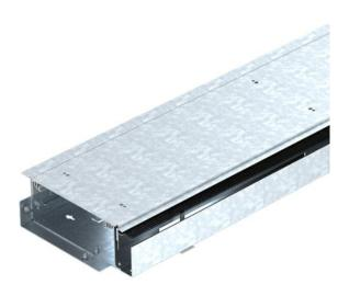
Montagefertige Kanaleinheit zur Leitungsführung und zum Geräteeinbau, bestehend aus einem Kanalunterteil mit zwei Deckeln, einer höhenverstellbarer Bürstenleiste und einem verstellbaren Bodenbelaganlegeprofil zur Estrichabgrenzung in Bereichen von Türlaibungen und vor Heizkörpernischen. Im Lieferumfang enthalten sind zwei Deckelstoßdichtungen und ein Verbinder. Zur Höheneinstellung werden sechs Nivelliereinheiten benötigt. Bis maximal 5 kN belastbar.
