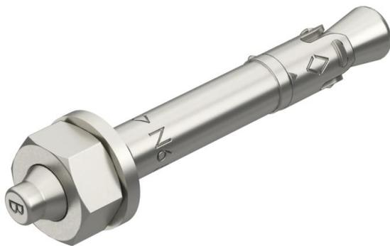
Der Nagelanker N ist einsetzbar für Mehrfachbefestigungen nichttragender Systeme in Bereichen mit hochkorrosiven Einflüssen in gerissenen und ungerissenen Beton und verbindet die Vorteile eines Bolzenankers mit einer noch einfacheren Montage.
