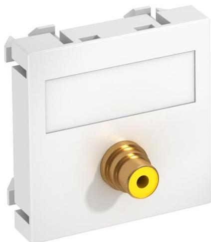
Multimediaträger mit einer Cinch-Anschlussbuchse für Composite Video, Kabelausschluss gerade, mit Beschriftungsfeld, Cinch-Kupplung (RCA) in Ausführung Buchse-Buchse, Farbkodierung gelb. Trägerplatte mit Rastbefestigung, geeignet für den waagerechten und senkrechten Einbau in die Systemumgebung.
