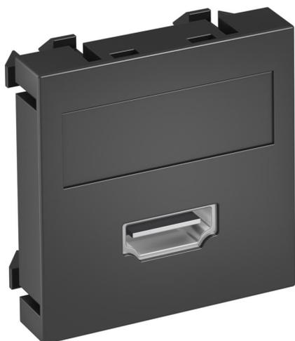
Multimediaträger mit einer HDMI Anschlussbuchse, Kabelauslass gerade, mit Beschriftungsfeld, HDMI Buchse mit Schraubanschluss. Trägerplatte mit Rastfestigung, geeignet für den waagerechten und senkrechten Einbau in die Systemumgebung.
