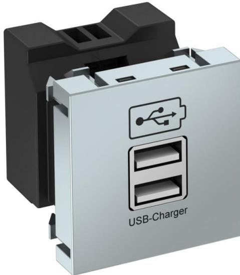
USB-Ladegerät mit zwei USB Typ A-Buchsen, für das Aufladen von 1-2 mobilen Geräten, maximaler Ladestrom 1x 2100 mA oder 2x 1050 mA.
