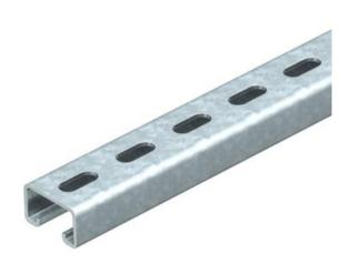
Schwere C-Profilschiene zur individuellen Installation von Tragekonstruktionen für z.B. Kabelrinnen oder als Konsole für Schaltschränke. Auch verwendbar zur Kabelverlegung, in Verbindung mit Bügelschellen mit U-Fuß.
