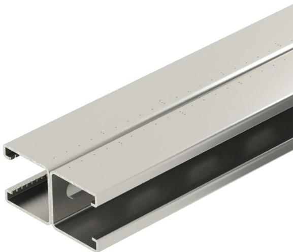
Profil-/Montageschiene mit durchgängiger Lochung im Boden in schwerer Ausführung und 22 mm Schlitzweite. In doppelter Ausführung, das heißt zwei Profilschienen sind am Boden miteinander verbunden (geschweißt).
