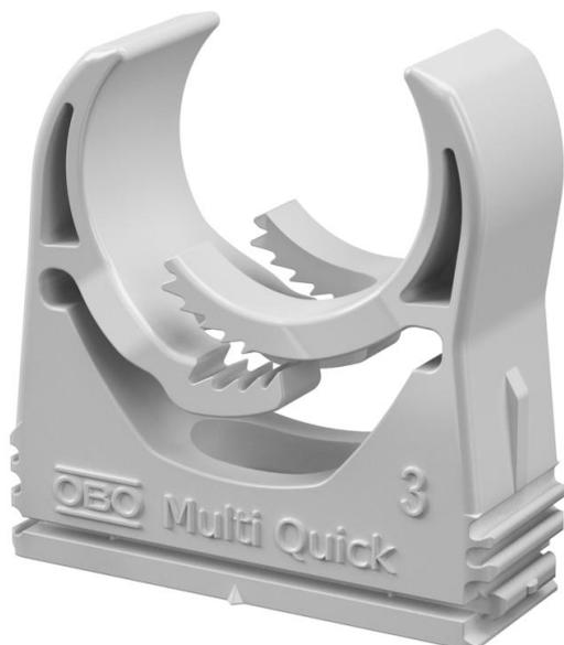
Aufputzschelle zur Aufnahme von metrischen und PG-Rohren sowie Elektroinstallationsrohr Quick-Pipe. Flexibler Spannungsbereich von mehreren Millimetern. Universelle Befestigungsmöglichkeiten an Wand und Decke und einsetzbar in Profilschiene im Innen- und geschützten Außenbereich. Werkzeuglose Rohrmontage. Aneinander reihbar auch mit OBO Quick- oder starQuick-Schelle.
