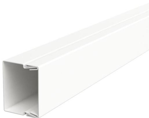
Kanaloberteil und -unterteil mit Bodenlochung. Der Potentialausgleich ist ohne weitere Hilfsmittel zwischen Unter- und Oberteil gewährleistet. Der LKM Leitungsführungskanal Typ LKM 20030 ist als Verlegesystem für Funktionserhalt nach DIN 4102 Teil 12 geprüft. Bitte beachten Sie die im Bereich BSS Brandschutz-Systeme geprüften Kabeltypen!
