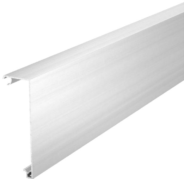
Kanalabdeckung zur Erstellung eines Design-Geräteeinbaukanals der Serie GAD. Designausführung "Style" zur vollständigen Abdeckung der Systemöffnung und der Schalt- und Steckgeräte. Die Obertheadapter GAD OTA sind zwingend erforderlich und sollten im max. Abstand von 50 cm auf der Kanalstrecke eingeplant werden. Zwischen den Kanalabdeckungen muss ein Distanzstück GAD OTD gesetzt werden.
