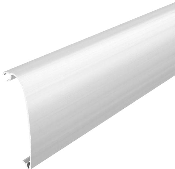
Kanalabdeckung zur Erstellung eines Design-Geräteeinbaukanals der Serie GAD. Designausführung "Soft" zur vollständigen Abdeckung der Systemöffnung und der Schalt- und Steckgeräte. Die Obertheadapter GAD OTA sind zwingend erforderlich und sollten im max. Abstand von 50 cm auf der Kanalstrecke eingeplant werden. Zwischen den Kanalabdeckungen muss ein Distanzstück GAD OTD gesetzt werden.
