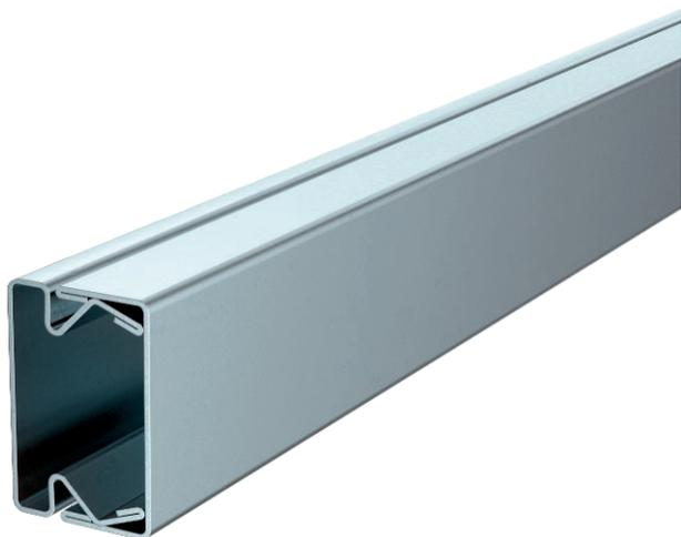
Kanaloberteil und -unterteil mit Bodenlochung. Der Potentialausgleich ist ohne weitere Hilfsmittel zwischen Unter- und Oberteil gewährleistet. Der LKM Leitungsführungskanal Typ LKM 20030FS ist als Verlegesystem für Funktionserhalt nach DIN 4102 Teil 12 geprüft. Bitte beachten Sie die im Bereich BSS Brandschutz-Systeme geprüften Kabeltypen!
