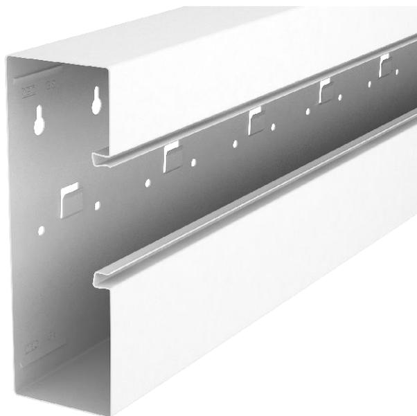
GS Geräteeinbaukanal zur Montage auf der Wand oder an Befestigungskonsolen. Der GS Geräteeinbaukanal verfügt über selbstkontaktierende Rastlaschen zur Aufnahme einer Trennwand aus Stahlblech. Der Potentialausgleich zwischen den Kanalunterteilen erfolgt über die Kupplung. Zwischen Oberteil und Unterteil wird die Schutzmaßnahme und der Potentialausgleich durch die patentierte, selbstkontaktierende Kanalabdeckung gewährleistet. Die Systemöffnung beträgt real 76,5 mm.
