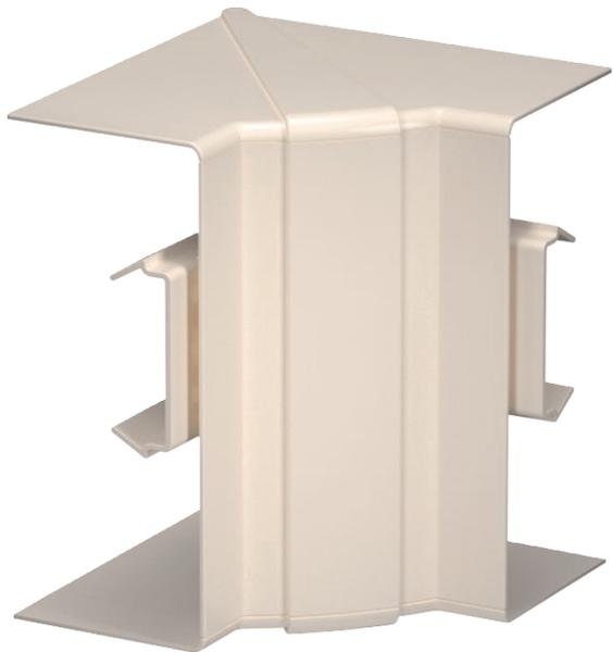
Inneneck-Haubenformteil aus halogenfreiem PC/ABS zur Richtungsänderung von Geräteeinbaukanälen Rapid 80 der Systeme GK, GKH, GS und GA. Die Formteile sind variabel von 85° - 95° verstellbar und einsetzbar für symmetrische und asymmetrische Kanäle.
