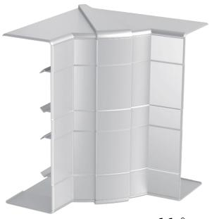
Inneneck zur Richtungsänderung von Gerätee<br/>inbaukanälen Rapid 45-2. Die Formteile sind variabel von 83° - 97° verstellbar.
