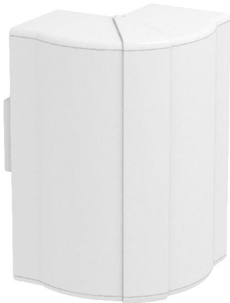
Außeneck-Haubenformteil aus halogenfreiem PC/ABS zur Richtungsänderung von Geräteeinbaukanälen Rapid 80 der Systeme GK, GKH, GS und GA. Die Formteile sind variabel von 80° - 100° verstellbar und einsetzbar für symmetrische und asymmetrische Kanäle.
