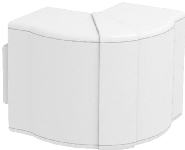
Außeneck-Haubenformteil aus halogenfreiem PC/ABS zur Richtungsänderung von Geräteeinbaukanälen Rapid 80 der Systeme GK, GKH, GS und GA. Die Formteile sind variabel von 80° - 100° verstellbar und einsetzbar für symmetrische und asymmetrische Kanäle.
