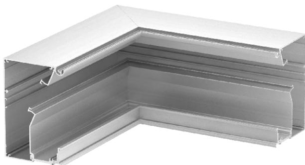
Inneneckunterteil zur Erstellung eines Design-Geräteeinbaukanals der Serie GAD. 45-mm-Systemöffnung zur Aufnahme von Modul 45 Schalt- und Steckgeräten und entsprechenden Oberteilen PVC und Aluminium der Serie Rapid 45. Das Formteil kann mit Formteilabdeckungen der Designs "Swing", "Soft" oder "Style" vervollständigt werden. Die Oberteiladapter GAD OTA sind zwingend erforderlich. Zwischen den Kanalabdeckungen muss ein Distanzstück GAD OTD gesetzt werden.
