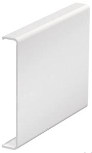
Oberteil aus Aluminium zum Verschließen der Rapid GA Geräteeinbaukanäle und ISS Installationssäulen mit 76,5er Systemöffnung. Der feste Sitz des Oberteils und die elektrische Kontaktierung zum Kanal-/Säulenunterteil ist durch die Rastklammern Typ RKV3V garantiert. In jeder Lieferlänge (100 mm) sind 2 Rastklammern vormontiert.
