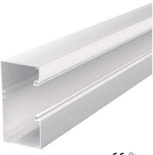
Geräteeinbaukanal ohne Bodenlochung zur direkten Wandmontage oder an Konsolen geeignet. Überlängen bis 6000 mm von Kanalunterteilen und -oberteilen sowie andere RAL-Farben können auf Anfrage realisiert werden. Die Sichtflächen der Geräteeinbaukanäle sind folliert.
