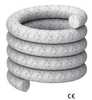
Die Schallschutzbarriere dient zur Minderung der Luftschall-Übertragung z. B. bei Führung des Kanalsystems durch Wanddurchbrüche zwischen zwei Büros. Die Schallschutzbarriere besteht aus Glaswolle, die im Lieferzustand einen Durchmesser von ca. 30 mm hat. Die Meterware wird in einem Karton angeliefert, die Länge des Materials ist 50 m. Das Material braucht bei der Montage nicht extrem komprimiert zu werden.
