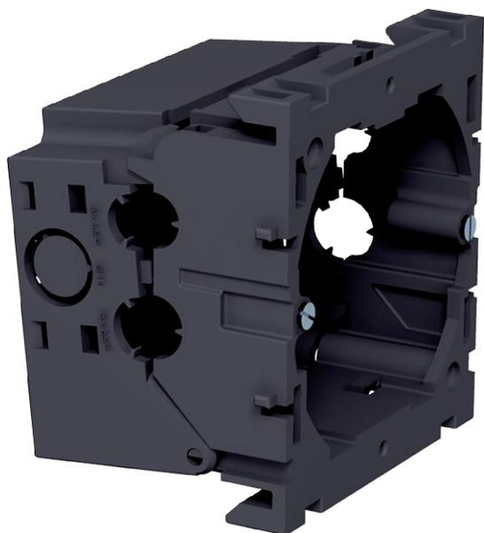
Frontrastende Geräteeinbaudose für Schalter-Systeme, mit abklappbarem und bei Bedarf auch entfernbarem Unterteil zum zeitsparenden Leitungsanschluss, mit Zuführöffnungen für Leitungsdurchmesser bis 14 mm. Halogenfreie Ausführung.
