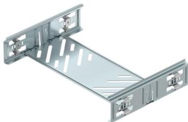
Kabelrinnenverbinder mit Schnellbefestigung für die schraubenlose Verbindung von gelochten Kabelrinnen mit der Seitenhöhe 60 mm. Durch die optimierte Bauform kann der Verbinder zur Herstellung von Radien und als Längenausgleichsstück bei großen Temperaturschwankungen eingesetzt werden.
