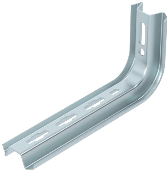
TP-Profil zur Verwendung als leichter Stiel an waagerechten Betondecken, in der Länge von 145-645 mm. Bis zur Länge 345 mm wird das Profil auch als leichter Wand- und Stielausleger eingesetzt.
