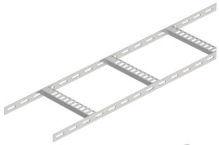
Schiffsbau-Kabelleiter mit gelochtem Seitenholm in der Seitenhöhe 25 mm, mit eingeschweißten, nach unten offenen und gelochten Trapezsprossen. Belastung geprüft nach IEC in Kombination mit Verbinder Typ SLV.
