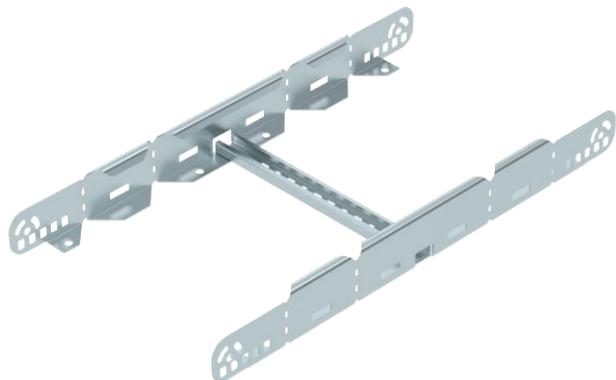
Multifunktionsverbinder zur Verbindung von Kabelleitern mit der Seitenhöhe 60mm. Es können symmetrische und asymmetrische Reduzierungen, stufenlose Bögen von 0-60° und Anbauabzweige erstellt werden.
