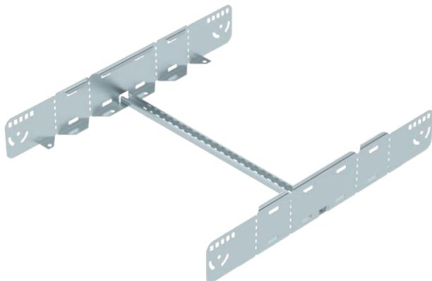
Multifunktionsverbinder zur Verbindung von Kabelleitern mit der Seitenhöhe 110 mm. Es können symmetrische und asymmetrische Reduzierungen, stufenlose Bögen von 0-60° und Anbauabzweige erstellt werden.
