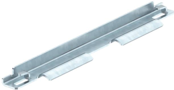
Gitterrinnenverbinder in langer Ausführung zur schraubenlosen Längsverbinding von Gitterrinnen. Pro Verbindungsstelle werden 2 Längsverbinder Typ GRV 245 eingesetzt. Einsetzbar ab einer Gitterrinnenbreite von 100mm. Die FS-Variante kommt für die Verbindung von galvanisch verzinkten Gitterrinnen zum Einsatz, die DD-Variante für die Verbindung von tauchfeuerverzinkten/feuerverzinkten Gitterrinnen und die VA-Variante für die Verbindung von Edelstahl-Gitterrinnen.
