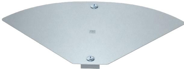
Deckel für den variablen Bogen, einstellbar in einem Winkel von 0 bis 90°, Arretierung durch Drehriegel und durch Überlappung mit Kabelrinnendeckel.
