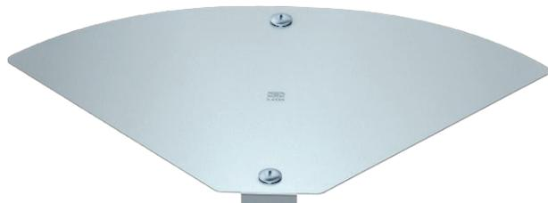
Deckel für den variablen Bogen, einstellbar in einem Winkel von 0 bis 90°, Arretierung durch Drehriegel und durch Überlappung mit Kabelrinnendeckel.
