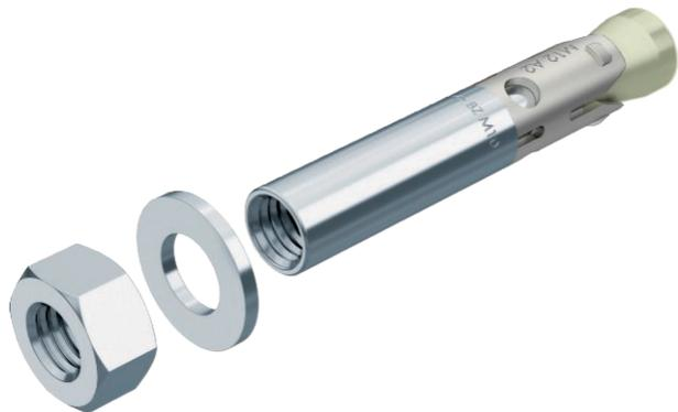
Bolzenanker BZ-IG mit Innengewinde zur Verankerung mittelschwerer bis schwerer Lasten, sowohl in gerissenen als auch ungerissenen Beton. Er vereint hohe zulässige Lasten mit geringen Rand- und Achsenabständen. Ein Hinterschnitt der Borhlöcher ist nicht erforderlich. Die Bauteilbefestigung ist außer mit Sechskantschrauben auch mit Senkkopfschrauben sowie einem System aus Mutter und Scheibe und einer handelsüblichen Gewindestange möglich.
