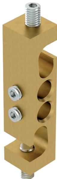
Zweifache Anschlussklemme zur Aufnahme von 2 Leiterseilen, zum Erstellen des Schutzpotentialausgleichs bei Kabeltragsystemen. Dient als Knotenpunkt für Abzweigungen und Kreuzungen. Montage an Leiterseil, mittig in Klemmfeder.
