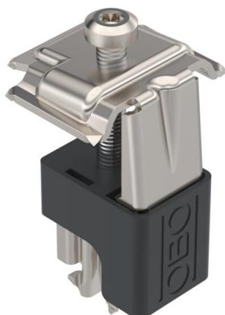
Universalklemme zum Montieren von Photovoltaik-Modulen auf Flach- und Schrägdächern, geeignet als Klemme zwischen 2 Modulen oder als Endklemme. Rastbare Vorbefestigung an Trägerprofil TP 45 sowie an Stützen STK und STL. Geeignet für Schlitzweite 10 mm. Nach Einrasten um 90° drehbar. Schraubbare Befestigung des PV-Moduls mit Schlüssel Torx 30.
