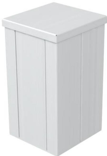
ISS Installationssäule 2-zügig aus Aluminium mit 76,5-mm-Systemöffnung. Leer, bestückbar mit handelsüblichen Geräten (Steckdose, Telefon, usw.), max. 4 Geräte.
