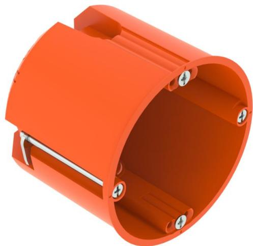
Hohlwand-Gerätedose für den Einsatz in Hohlwänden mit einer Einbautiefe von mindestens 61 mm und einer Plattenstärke von 5 - 40 mm.
