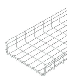
Gitterrinne mit angeformtem Verbinder in der Seitenhöhe 105 mm. Für die Gitterrinne werden keine zusätzlichen Verbinderbauteile benötigt, sie wird einfach ineinandergesteckt. Die Maschenweite beträgt 50 x 100 mm. Magnetische Schirmdämpfung ohne Deckel 15 dB, mit Deckel 25 dB.
